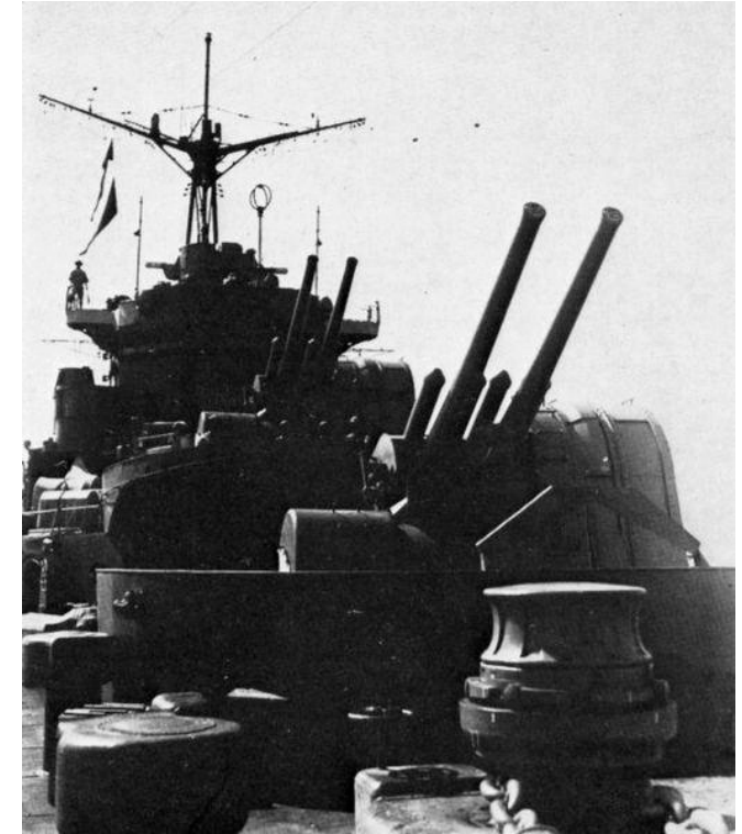
El tipo 89 de 127mm en montajes dobles
