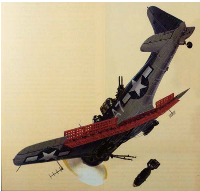
SBD-2 Dauntless haciendo un bombardeo en picado. Nótese los aerofrenos de color rojo desplegados en el borde posterior de las alas.
