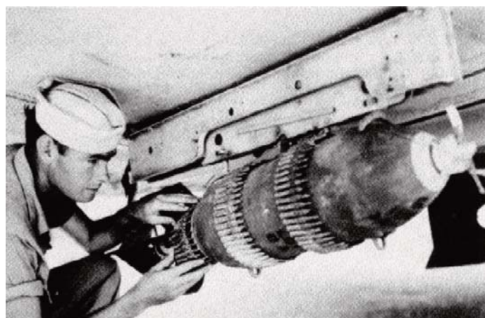
Bomba de 100 libras (45kg), apodada Daisy Cutter o "segadora de margaritas" montada en la panza de un SBD-3 Dauntless en Guadalcanal. Nótese las cintas de munición de ametralladora adosadas para multiplicar el efecto de la metralla.
