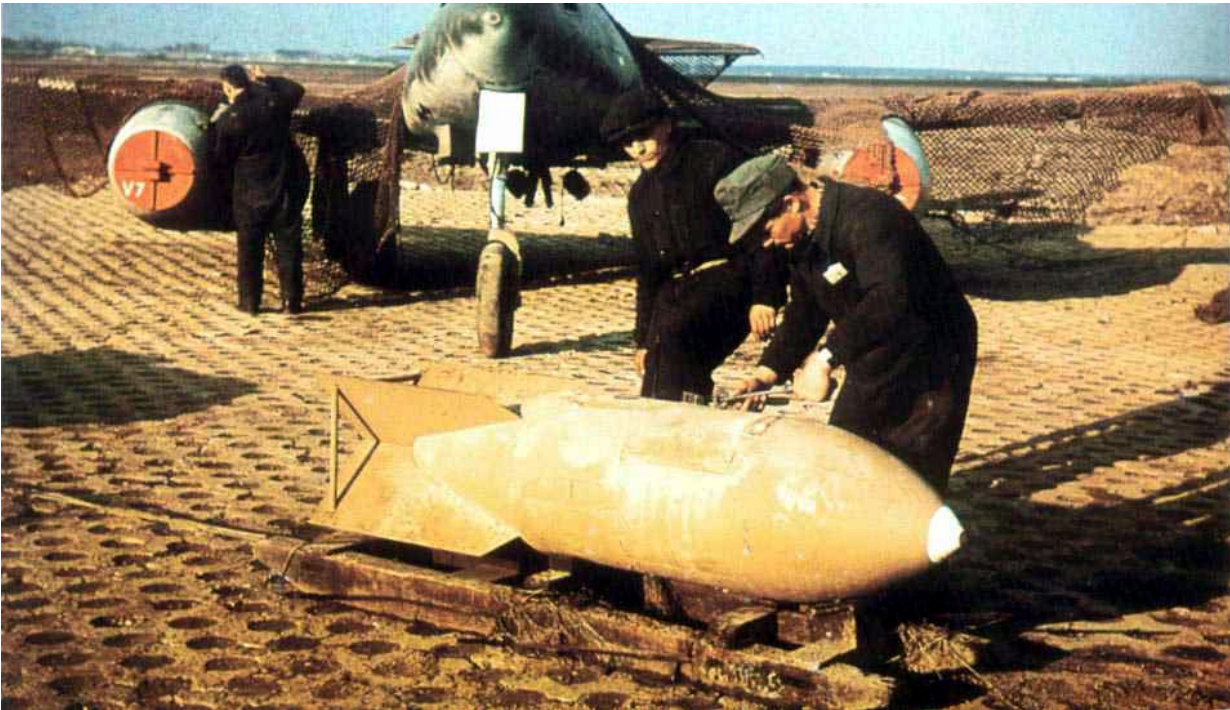
Artilleros armando una bomba para montarla en un Me 262 A-2a.
